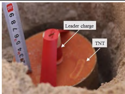
图 6 试验用 TNT 及其起爆方式 Fig. 6 TNT and its initiation charge
