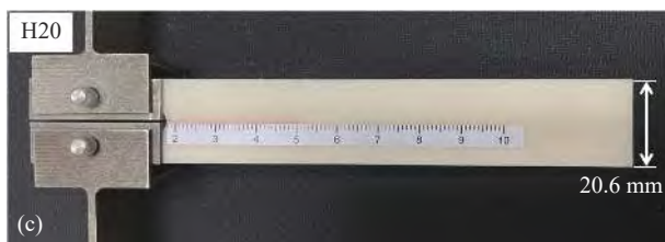
图5 厚度为 5.2 mm (H5) (a)、10.3 mm (H10) (b) 和 20.6 mm (H20) (c) 的 DCB 试件
