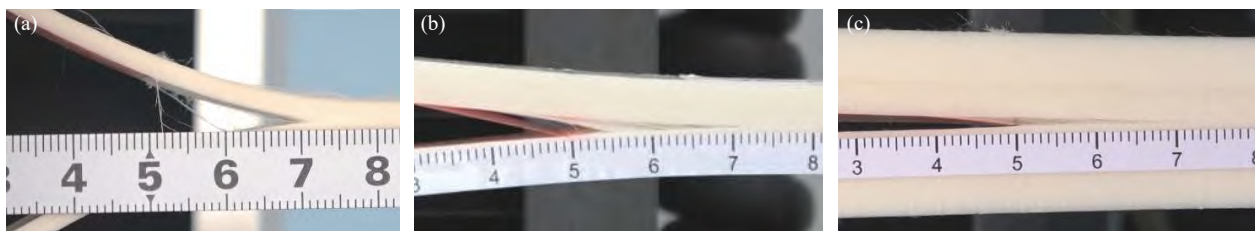
图 10 试验过程中 DCB 试件的变形对比: (a) H5; (b) H10; (c) H20
