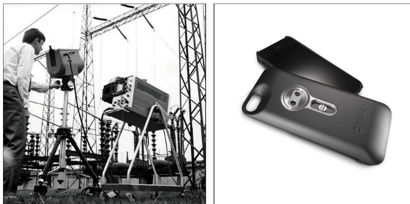
图 22.2 左图：Thermovision 661 型诞生于 1969 年。这款热像仪重量大约在 25 千克左右，示波器重 20 千克，三脚架重 15 千克。操作员还需要一个 220 VAC 的发电机组，以及一个装有液氮的 10 升液罐。在示波器的左边，可以看见 Polaroid 配件（6 千克）。右图：FLIR One 2014 年 2 月推出，是一款滑动式附件，为 iPhone 提供了热成像功能。重量为 90 克。
