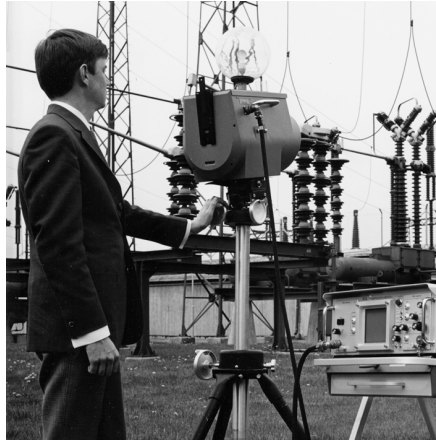
图 14.2 1969：Thermovision 661 型。这款热像仪重量大约在 25 kg 左右，示波器重约 20 kg，三脚架重约 15 kg。操作员还需要一个 220 VAC 的发电机组，以及一个装有液氮的 10 L 液罐。在示波器的左边，可以看见 Polaroid 配件（6 kg）。
